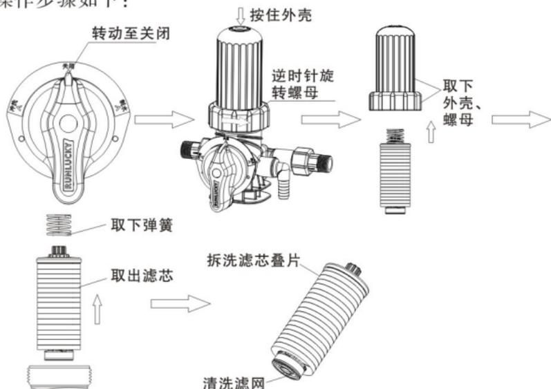
清洗完成后，倒置以上步骤，将所有零件装配到位，检查密封后便可继续使用。
