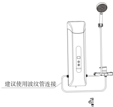
图6主机放置于混水阀左侧的安装示意图
