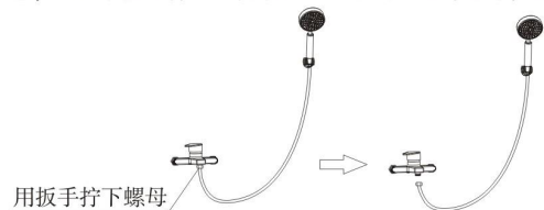
图4 拧开喷头和混水阀的螺母
